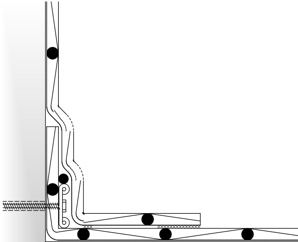
Randfixierung mit Befestigungsschiene vertikal
