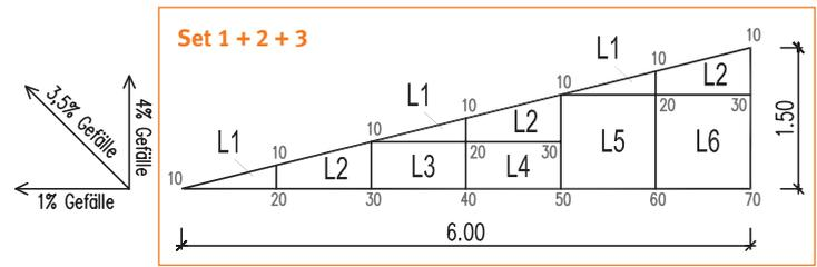
Die Sets gibt es für Linienentwässerungssysteme bis 10 m Länge. Sollten größere Längen benötigt werden (LES 11, LES 12, ...), so können diese nach wie vor noch bestellt werden. Diese werden aber nicht als Sets gefertigt, sondern wie seither objektspezifisch mit den eingangs genannten bzw. vom alten System bekannten Gegebenheiten – unter anderem mit einer verlängerten Lieferzeit.
