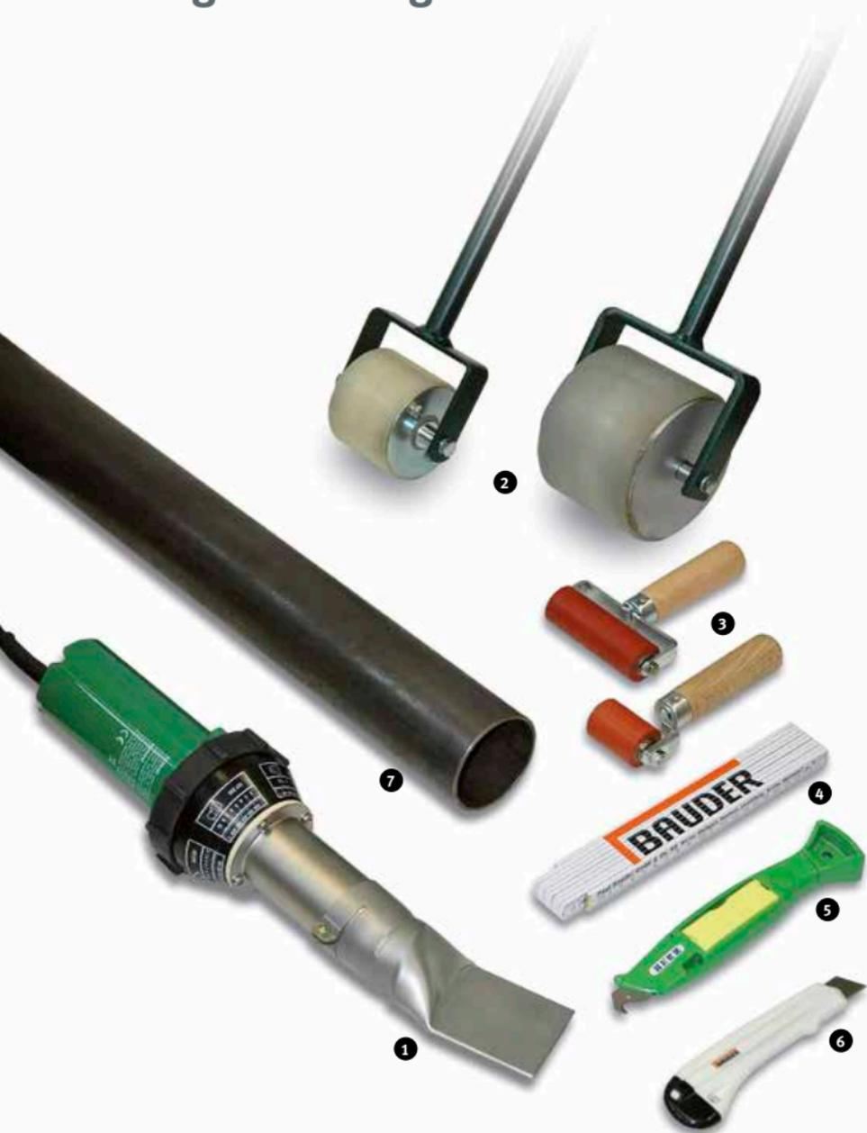
Für die fachgerechte Verarbeitung der Bauder Bitumenbahnen sind nicht viele Verlegewerkzeuge nötig. Neben den üblichen Dachdecker-Werkzeugen für die Verarbeitung von Schweißbahnen werden Andrückrollen, Cuttermesser und ein Heißluftfön oder kleiner Brenner für die Verarbeitung von Kaltselfstklebebahnen eingesetzt.
