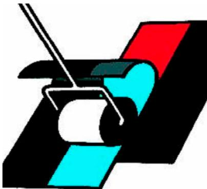
Bei Außentemperaturen über +10 °C und Verlegung Zug-um-Zug kann die blaue Naht in gewohnter Weise kalt verklebt werden: unterseitige Schutzfolie abziehen dann Nähte und Stöße unter hohem Anpressdruck mit einer Andrückrolle schließen. Die Verlegung beginnt in diesem Fall mit dem blauen Randstreifen am Dachrand.
