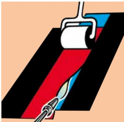
Erlaubt die Witterung keine Kaltverklebung der Nähte oder ist eine Zug-um-Zug-Verlegung nicht möglich, wird die rot markierte Längsnaht verschweißt. In diesem Fall wird die erste Bahnenreihe mit dem roten Randstreifen am Dachrand verlegt. Bei nachträglichem Wechsel von Kalt- zu Heiß-
