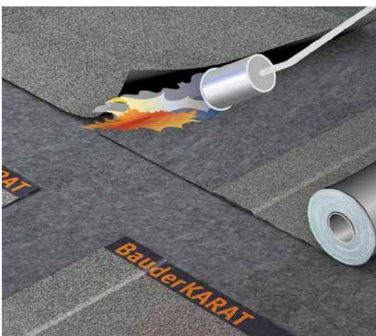
Auf allen vier außenliegenden Seiten des Dehnfugenbandes die Bauder Abdichtungsoberlage verlegen und ca. 12,5 cm beidseitig auf die Dehnfugenbänder aufschweißen.
