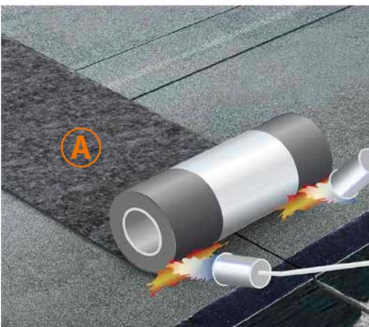
Das Dehnfugenband **A** mittig über der Fuge platzieren, dabei den Aluminiumstreifen nach unten ausrichten und auf beiden Seiten verschweißen. Brenner vom Aluminium weg richten.
