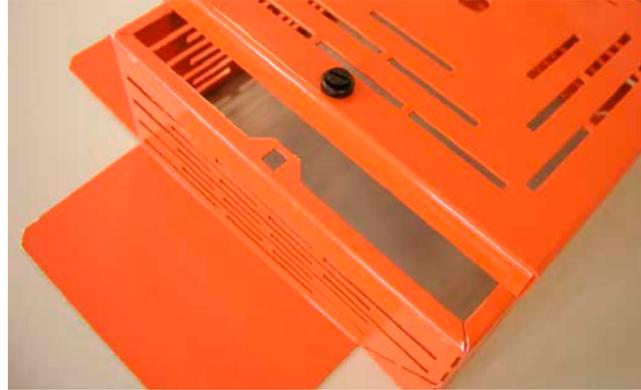
**Deckel mit Vierteldrehung-Druckschnellverschluss:** Hintere Laschen einhängen, Schnellverschluss mit einer Vierteldrehung und leichtem Druck verriegeln, bzw. mit einer Vierteldrehung öffnen (z. B. mit Münze)
